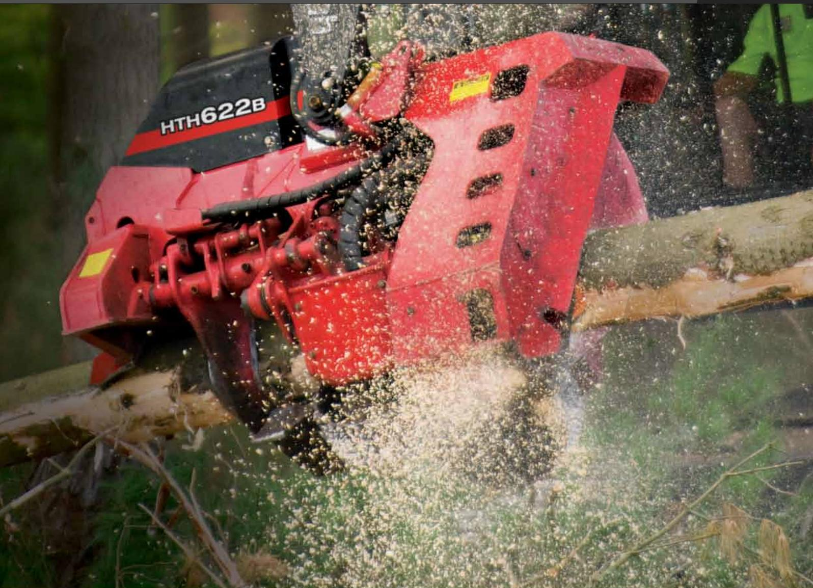
O cabeçote processador pesado, mais popular e abrangente do mercado. O Waratah HTH622B foi projetado para atender uma ampla variedade de aplicações, nas condições mais inóspitas. O HTH622B é altamente eficiente, tanto em operações de corte no tamanho, como no processamento à beira de estradas. Os recursos tecnológicos, a serra de topo e o sistema de medição TimberRite™ trabalham juntos, para resultados inteligentes de processamento e precisão extraordinária.
